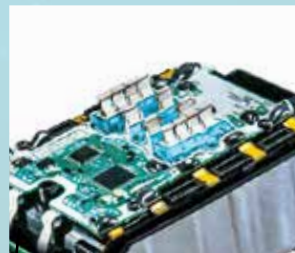
Struktur zur Verhinderung von Kurzschlüssen
